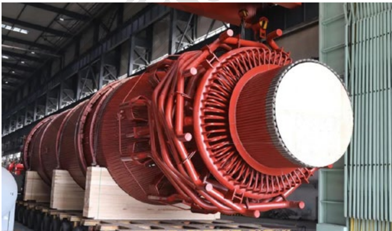
东方锅炉制造的世界单炉最大干煤粉辐射废锅流程“华谊气化炉”
