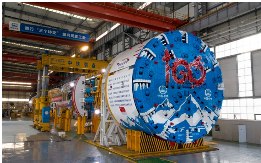
国产首台高原高寒大直径TBM“雪域先锋”号
